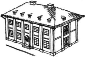
16 Le désir d'avoir des fenêtres toujours plus grandes dans les bâtiments urbains conduit aux constructions à piliers, qui correspondent aux constructions à supports en bois (fig. 10).
