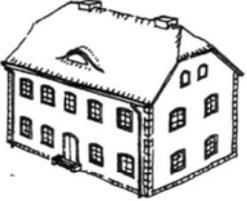
15 Plus tard, on encadre les ouvertures et on maçonne les angles en pierre de taille soigneusement travaillée ; on remplit les murs restants avec de la maçonnerie en moellons irréguliers que l'on enduit.
