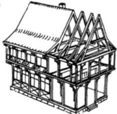
10 Dans des régions plus pauvres en bois s'est développé un genre de construction à poteaux (poteaux isolés, fenêtres entre les poteaux et étréssillonement dans les allèges des fenêtres).
