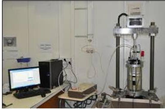
*Figure 5.3- Dispositif d'un essai triaxial cyclique*
