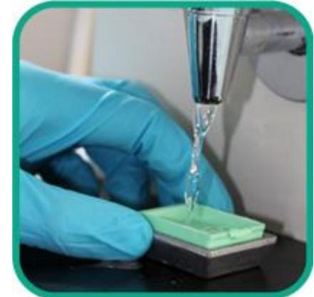
NB: Le remplacement de l'eau par la paraffine n'est pas directement possible: ces deux liquides n'étant pas miscibles. On doit en premier lieu substituer à l'eau des cellules fixées de l'éthanol, puis du toluène qui peut se mélanger à la paraffine liquide chaude. On peut aussi durcir avec la congélation.
