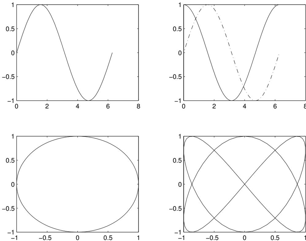
L'idée générale est de découper la fenêtre graphique en pavés de même taille, et d'afficher un graphe dans chaque pavé. On utilise l'instruction **subplot** en lui spécifiant le nombre de pavés sur la hauteur, le nombre de pavés sur la largeur, et le numéro du pavé dans lequel on va tracer :
