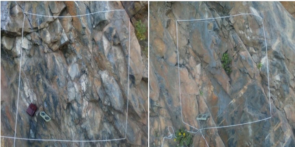
**Fig VII.8** : des photos de fenêtres réalisées pour estimer le nombre de joints par m<sup>2</sup>
