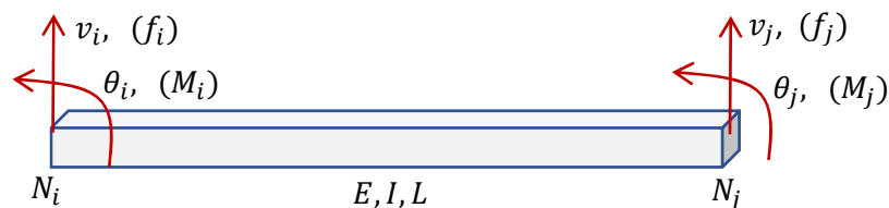
Figure II.1. Élément poutre et signe conventionnel de l'effort tranchant et moment fléchissant
