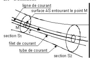
**Ligne de courant** : En régime stationnaire, on appelle ligne de courant la courbe suivant laquelle se déplace un élément de fluide. Une ligne de courant est tangente en chacun de ses points au vecteur vitesse du fluide en ce point.
