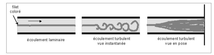
Dans ces conditions on distingue deux régimes d'écoulement différents pour un fluide réel :
