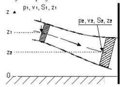
On considère un écoulement permanent isovolume d'un fluide parfait, entre les sections S<sub>1</sub> et S<sub>2</sub>, entre lesquelles il n'y a aucune machine hydraulique, (pas de pompe, ni de turbine).
