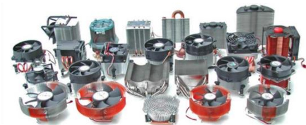
Figure VII.3. Exemples de systèmes de refroidissement à air pulsé
