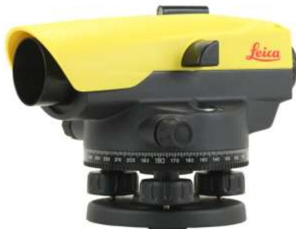
**Le nivellement direct** consiste à déterminer la "dénivelée  $\Delta H_{AB}$ " entre deux points **A** et **B** à l'aide d'un "niveau", et par une échelle verticale appelée "mire". Le niveau est constitué d'une optique de visée tournant autour d'un axe principale (axe vertical) : il définit donc un plan de visée horizontal (figure ci-dessous).
