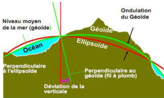
Figure 3. Représentation de l'ensemble de L'ellipsoïde de révolution, du géoïde et de la surface de la terre (échelle amplifiée).
