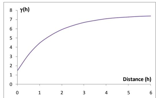
**Modèle gaussien de paramètre et de palier :** parabolique à l'origine
