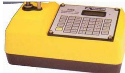
Les résultats affichés automatiquement permettent une lecture rapide des différents paramètres de la mesure tels que : - Profondeur de mesure (mm) - Epaisseur de la couche de roulement (mm) - Durée de comptage - Densité Humide (kg/m<sup>3</sup>) - Teneur en eau (%) - Indice des vides (%) - Compacité (%) - Référence de compacité
