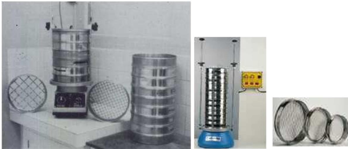
*Figure : Photos d'une série de tamis avec une tamiseuse électronique.*
