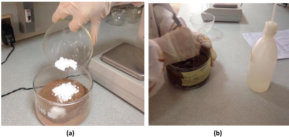
Fig. 3.7 : Préparation de la pâte du sol avec de l'eau distillée en présence ou en absence du sulfate et la chaux pendant 1, 15 jours
