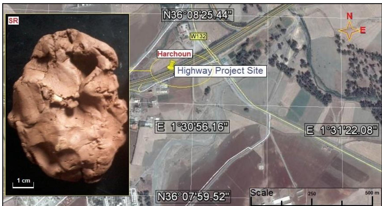
Fig. 3.1 : Prélèvement du sol argileux rouge (SR) à partir d'un projet d'autoroute Est-Ouest (Harchoun, Algérie).
