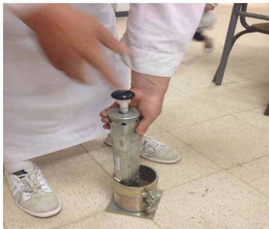
Fig. 3.11 : Compactage du sol (Proctor normal)
