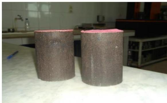
Figure V.12 – Eprouvette après confection pour soumettre l'essai Duriez.
