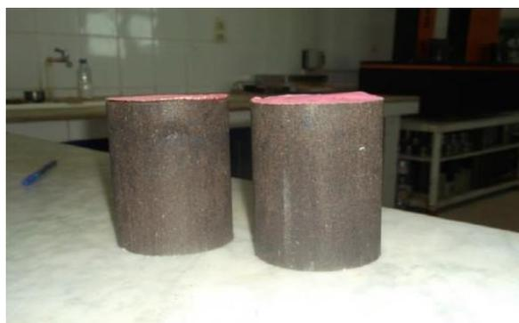
Figure V.12 – Eprouvette après confection pour soumettre l'essai Duriez.
