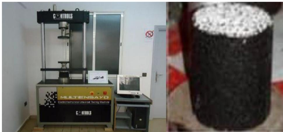
Figure V.7 – Machine de l'essai Duriez avec l'exemple d'une éprouvette confectionnée.
