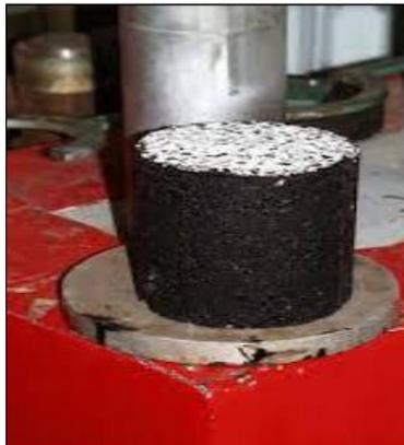
Figure V.10 – Eprouvette après confection pour soumettre l'essai Marshall.
