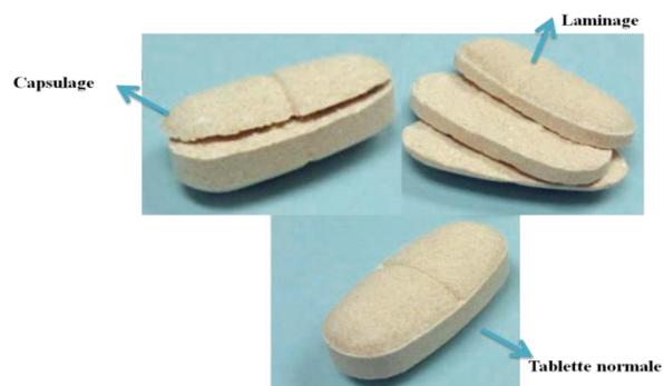
**Fig.19** Laminage et capsulage de comprimés. Adapté de la Réf (Brunaugh, Smyth et al. 2019).
