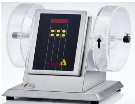
**Fig.20** Friabilimètre. (Source : <https://www.directindustry.fr/prod/pharma-test-apparetebau-ag/product-35060-1679146.html>)
