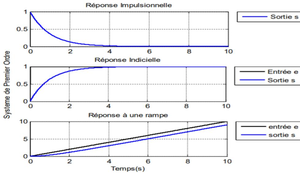
FIGURE 3.4 – Réponse d'un système à des entrées différentes
