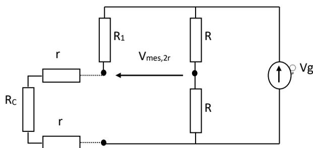
Figure 2 : Montage en pont, du capteur éloigné
