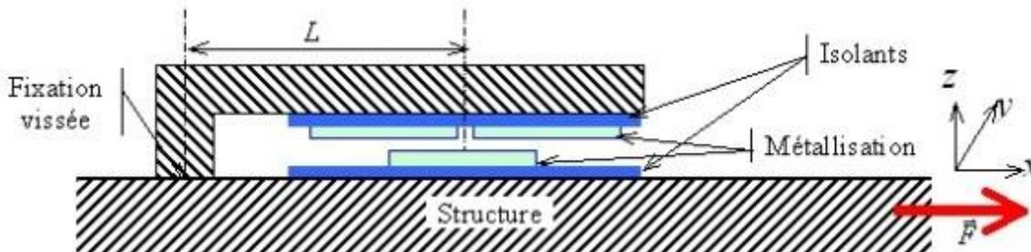
Figure 1 : Principe de la jauge capacitive haute température
