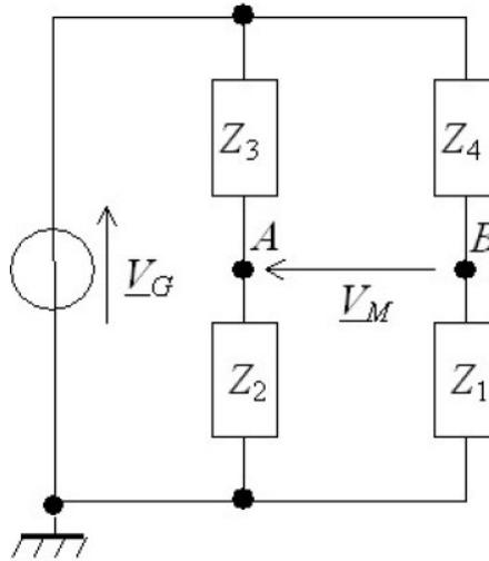
Figure 3 : Montage en pont de Wheatstone
