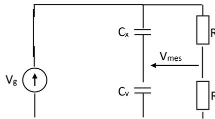
**Circuit de conditionnement du capteur**
