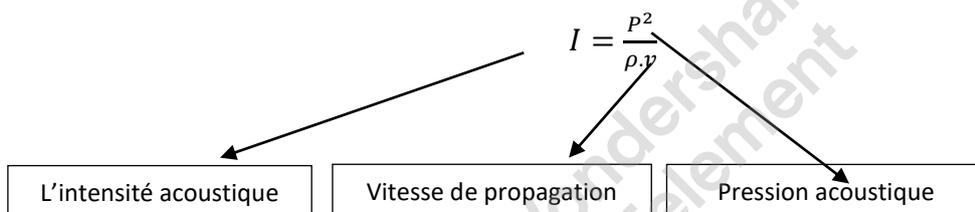
$$[I] = \frac{[P]}{[\rho][v]} = \frac{\text{Kg}^{-2} \cdot \text{m}^{-2} \cdot \text{s}^{-4}}{\text{Kg} \cdot \text{m}^{-3} \cdot \text{m} \cdot \text{s}^{-1}} = \text{Kg} \cdot \text{s}^{-3}$$
