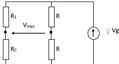
Figure 1 : Montage en pont du capteur
