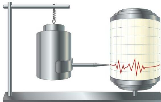
**Fig. 3.4- Sismomètre**
