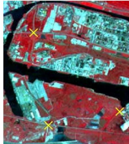
La seconde étape consiste à calculer la relation entre points source et points de référence. Plus il y a de déformations et plus il faut utiliser un modèle de déformation de degré élevé (c'est à dire un polynôme de déformation à degré élevé) et plus le nombre de points d'amer nécessaire est élevé. Le nombre minimal de points d'amer peut être calculé de la façon suivante :
