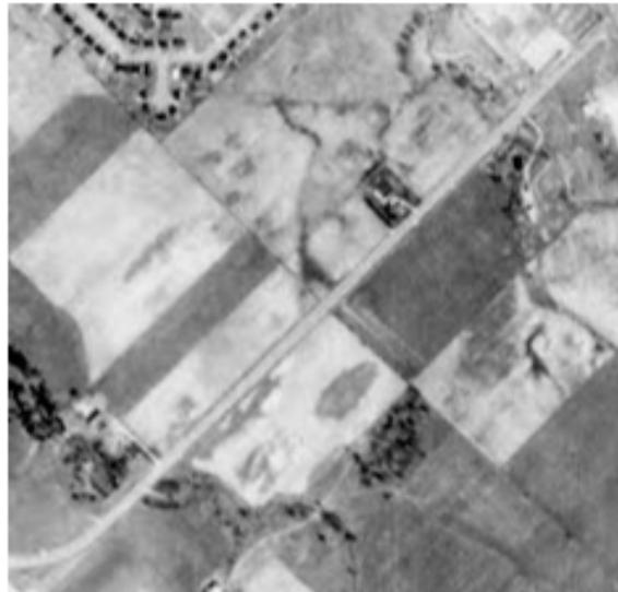
Le **ton** réfère à la clarté relative ou la couleur (teinte) des objets dans une image. Généralement, la nuance de ton est l'élément fondamental pour différencier les cibles et les structures. Les variations de ton permettent aussi la différenciation des formes, textures et patrons des objets.
