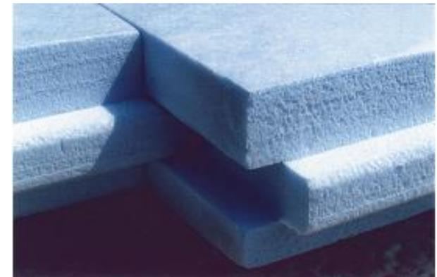
Fig. Polystyrène extrudé
