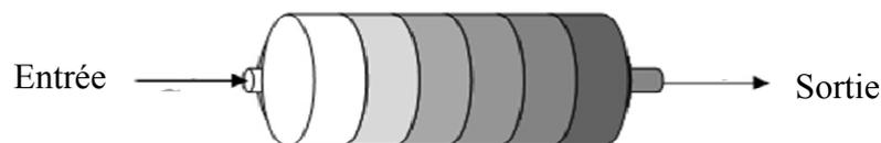
**Figure 1.6** – Réacteurs à écoulement piston
