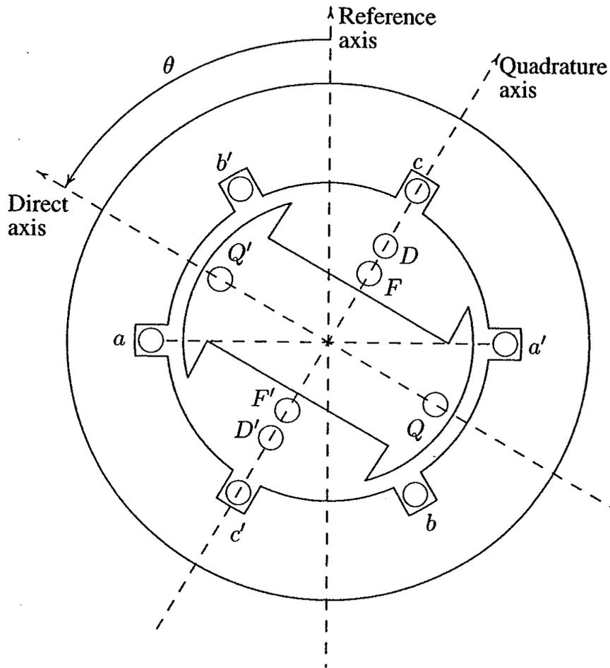
Les circuits statoriques et rotoriques peuvent être représentés par le schéma suivant, et ceci en négligeant la saturation et en supposant que les fmm sont sinusoïdales.
