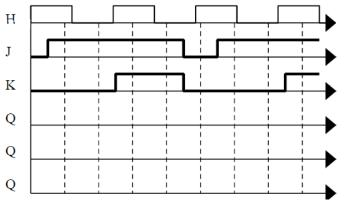
2) Compléter les chronogrammes de Q en fonction de H (bascule JK sur impulsion (Q=0 à t=0)) Quel est le rapport entre la fréquence du signal présent en Q et celle de H ? Comment appelle-t-on ce montage ?
