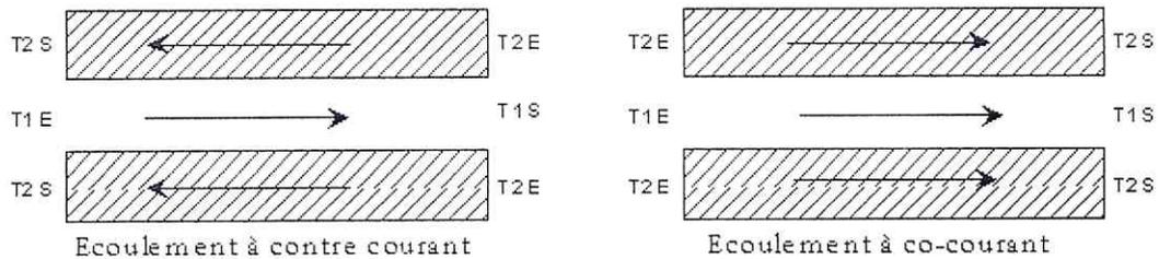
En supposant constant le coefficient de transfert global  $U$  entre les deux extrémités de l'échangeur, un bilan thermique dans l'échangeur permet de montrer que :
