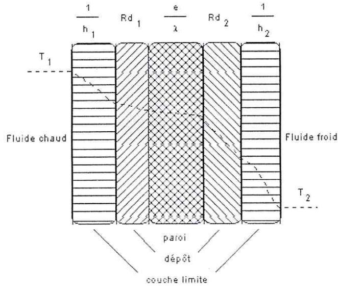
$R_1 = 1/h_1$  : est la résistance de transfert par convection côté fluide chaud.
