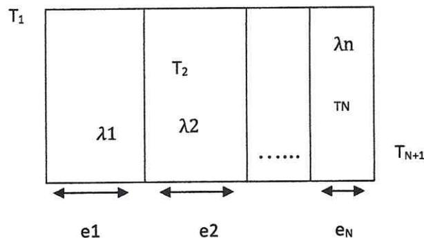
Soit un mur composite de plusieurs couches d'épaisseur  $e_1, \dots, \dots, e_N$  de surface  $S$ , de conductivité thermique  $\lambda_1, \dots, \dots, \lambda_N$
