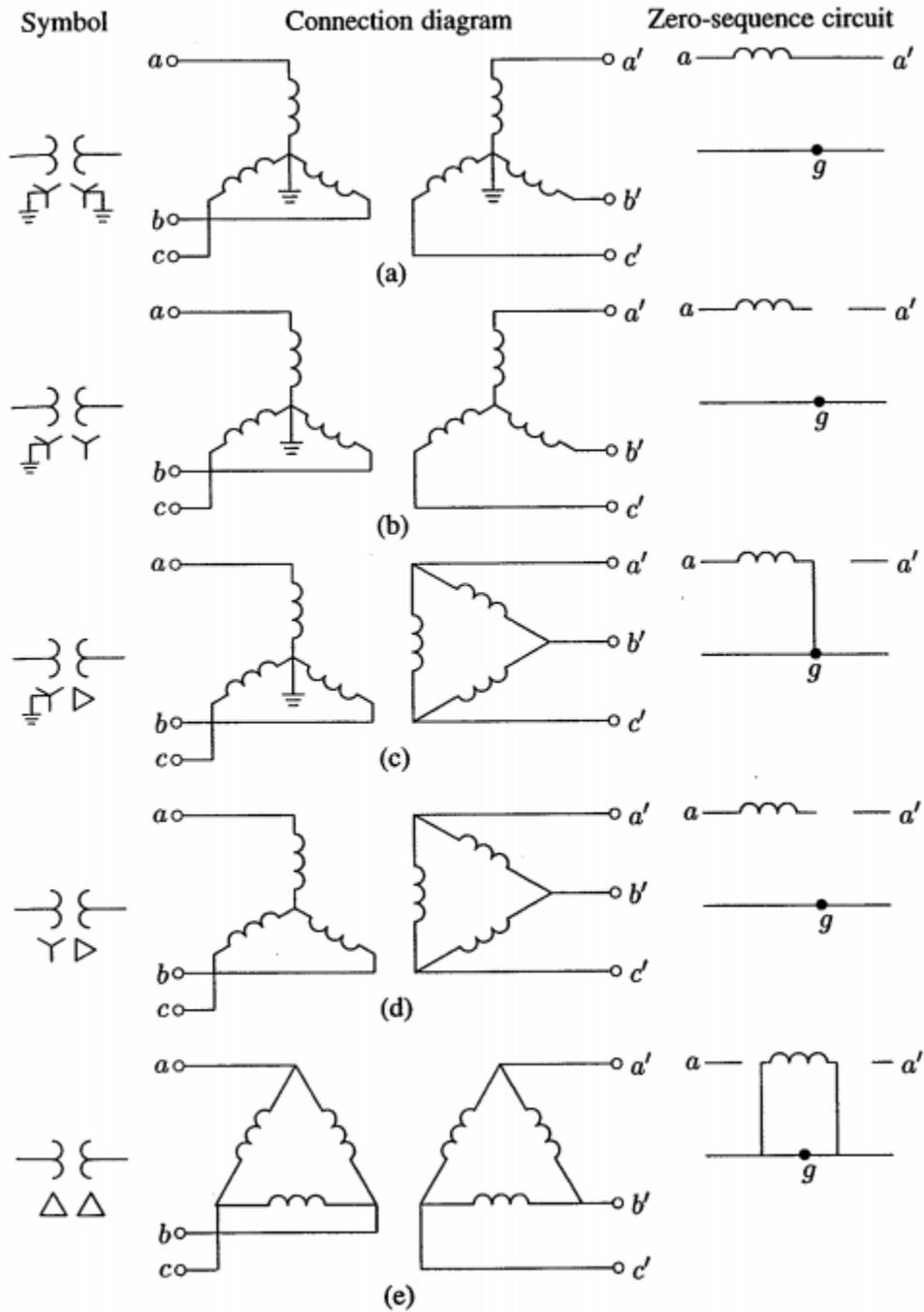
Figure 1 : Circuit équivalent d'un transformateur (séquence homopolaire)
