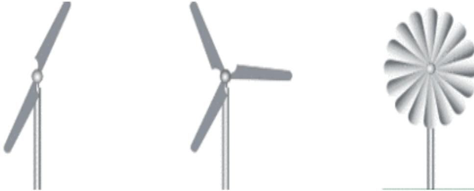
Figure III-3: *Eoliennes à axe horizontal.*
