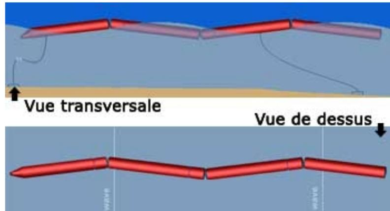
Figure IV-8: Houlomotrice avec des caissons flottants.
