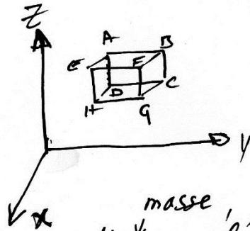
Considérons dans cette masse, un élément infiniment petit parallélépipède rectangle dont les arêtes  $dx, dy, dz$  sont parallèles aux axes.
