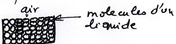
La disposition schématisée des molécules d'un liquide ci-dessus montre qu'une molécule à la surface de séparation de deux milieux (liquides différents, liquide - gaz),
