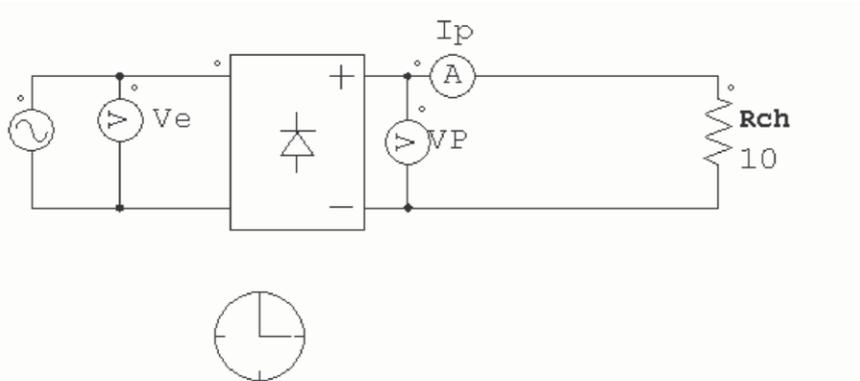
Observer l'allure des signaux  $v_E(t)$ ,  $v_P(t)$  et  $i_P(t)$  ; déterminer le *taux d'ondulation* de  $v_P(t)$  et  $i_P(t)$ .
