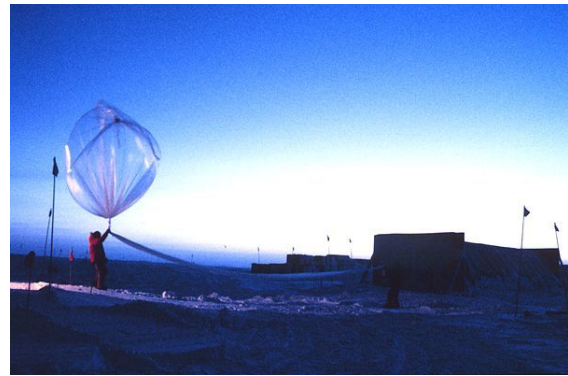
Un ballon-sonde, un des outils récents utilisés pour collecter des données environnementales.
