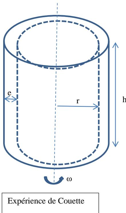
En entraînant le cylindre extérieur avec une vitesse angulaire constante  $\omega$ , on constate que le cylindre intérieur a tendance à tourner dans le même sens. Pour le maintenir immobile. Il faut donc lui appliquer un couple de sens opposé.
