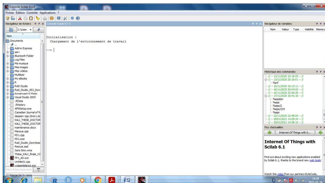
Dans la fenêtre au centre : Console Scilab 6.1.0, le signe - - > signifie que Scilab est en attente d'une commande.
