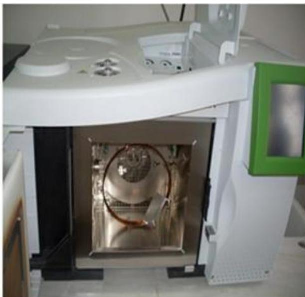
**Fig.1** (a) et (b) schéma et photo d'un appareil de chromatographie gaz
