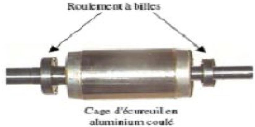
rotor d'une machine asynchrone
