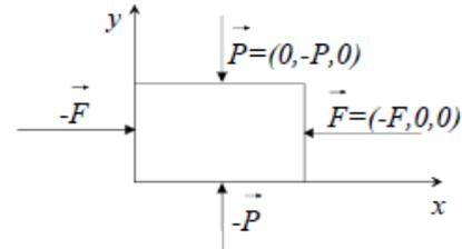
En notant  $F$  et  $P$  le module des forces  $\vec{F}$  et  $\vec{P}$ , donner dans le repère  $xyz$  la matrice du tenseur des contraintes auquel est soumis le bloc. On notera  $\sigma^I$  cette matrice.
