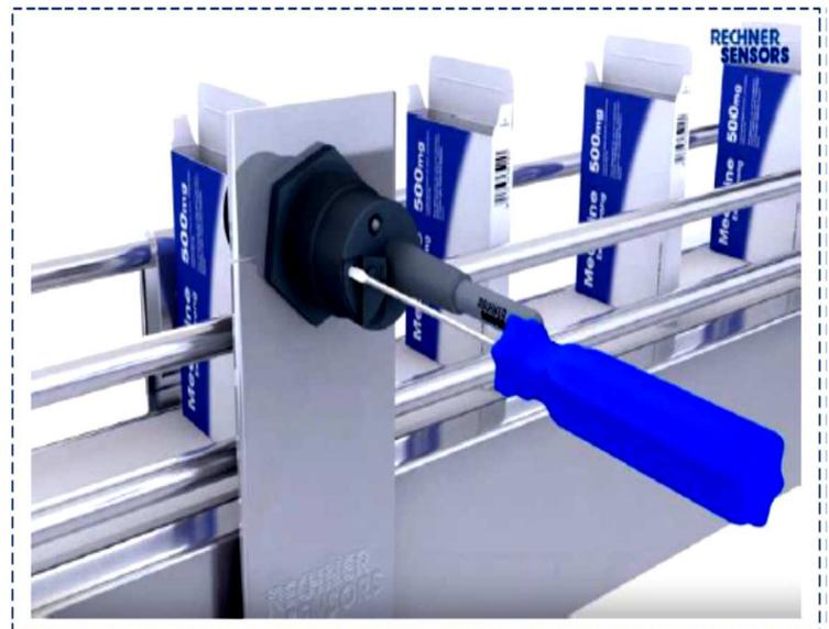
Exemple typique à la détection d'emballage de médicament sur une bande transporteuse
