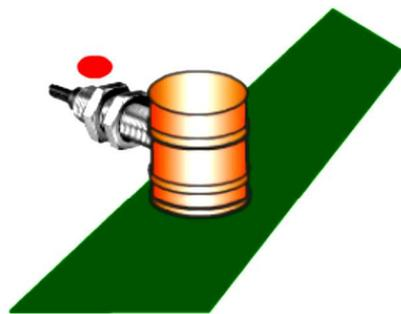
Détection de présence d'un bidon métallique.
