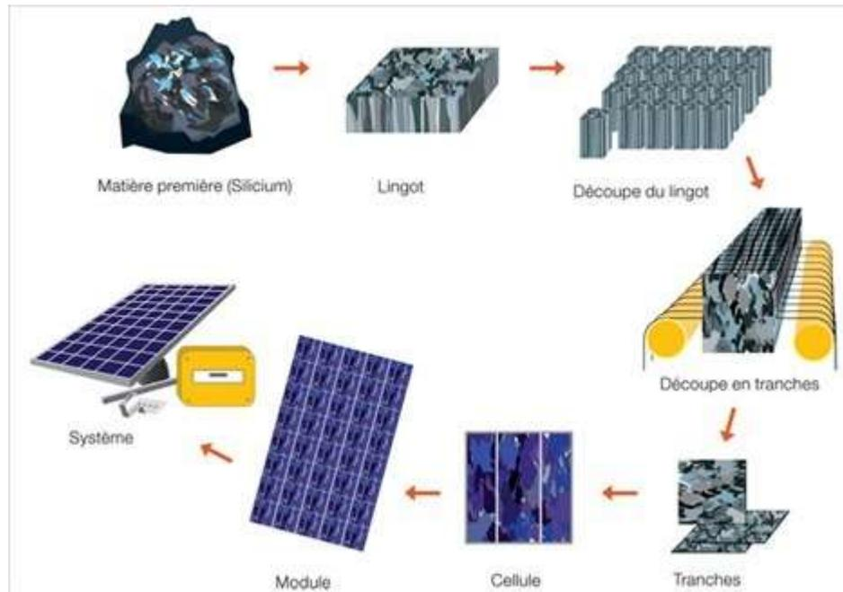
figure 2.4- procédé de fabrication de la cellule photovoltaïque
