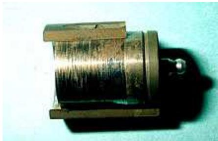
◆ **Corrosion sous contrainte mécanique** : Ce type de corrosion se définit comme un processus de développement de fissures, pouvant aller jusqu'à la rupture complète de la pièce sous l'action combinée d'une tension mécanique et d'un milieu corrosif. Ce sont des contraintes de tension, d'où le nom donné parfois à ce mode de corrosion, qui sont dangereuses ; les contraintes de compression exerçant au contraire une action protectrice.
