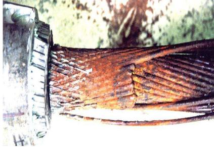
◆ **Corrosion fissurante** : Dans ce cas le matériau serait accessible par une attaque localisée par l'intermédiaire d'un milieu agressif qui agit à l'emplacement d'application d'une contrainte mécanique.
