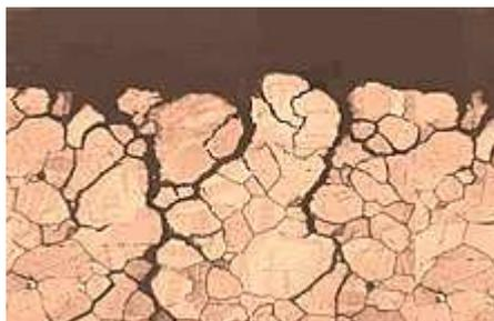
◆ **Corrosion- fatigue** : La corrosion-fatigue se distingue de la corrosion sous contrainte par le fait que les contraintes appliquées sont plus statiques, mais cycliques (efforts périodiques alternés). Le teneur en oxygène du milieu, sa température, son acidité, sa composition sont d'une grande influence sur la sensibilité d'un matériau à ce mode de corrosion.
