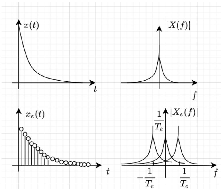
2. On tronque la suite  $x_e(nT_e)$  en ne conservant qu'un nombre fini  $N$  de termes pour obtenir le signal  $x_{tr}(t)$  formé des échantillons:  $x(0) \dots x((N - 1)T_e)$ :
