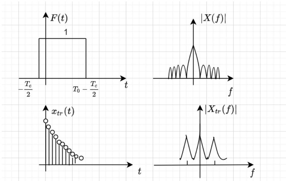
La convolution avec un sinus cardinal introduit des ondulations sur le spectre.
