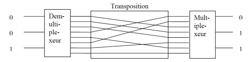
Trois bits sélectionnent un fil en sortie, ensuite l'ensemble subit une transposition et le résultat est remultiplexé sur 3 bits.
