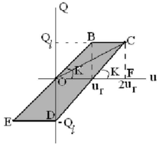
*Figure 2- Boucle hystérique d'un modèle élastoplastique*
