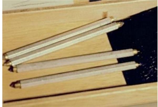
*Tiges serties de minéraux pour la mesure des duretés comprises entre 5 et 9.*
