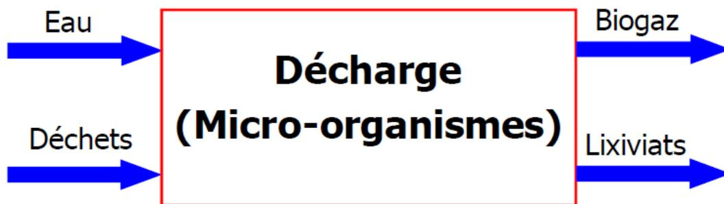
Figure 27 : Représentation schématique d'une décharge.
