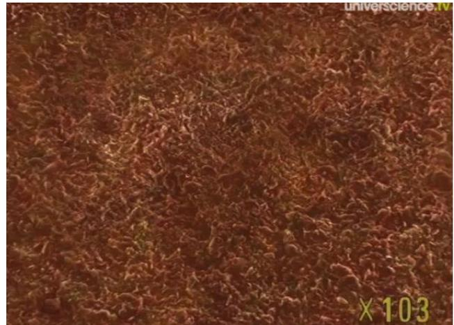
Argile vue au microscope optique
