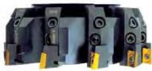
a – Fraise à surfacer à plaquettes carbure
