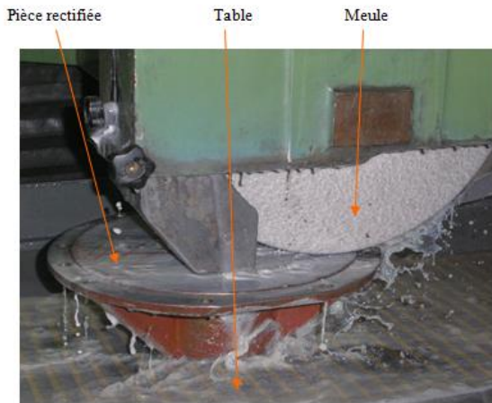
Fig. 31 : Opération de rectification plane
