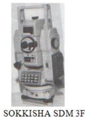
Figure 3.2- tachéomètre intégré
