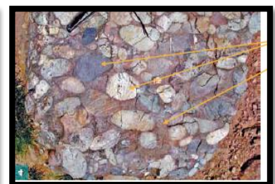
Ortho-conglomérat polygénique à ciment gréseux et éléments de différentes nature (quartzite-gneiss- quartz...)
