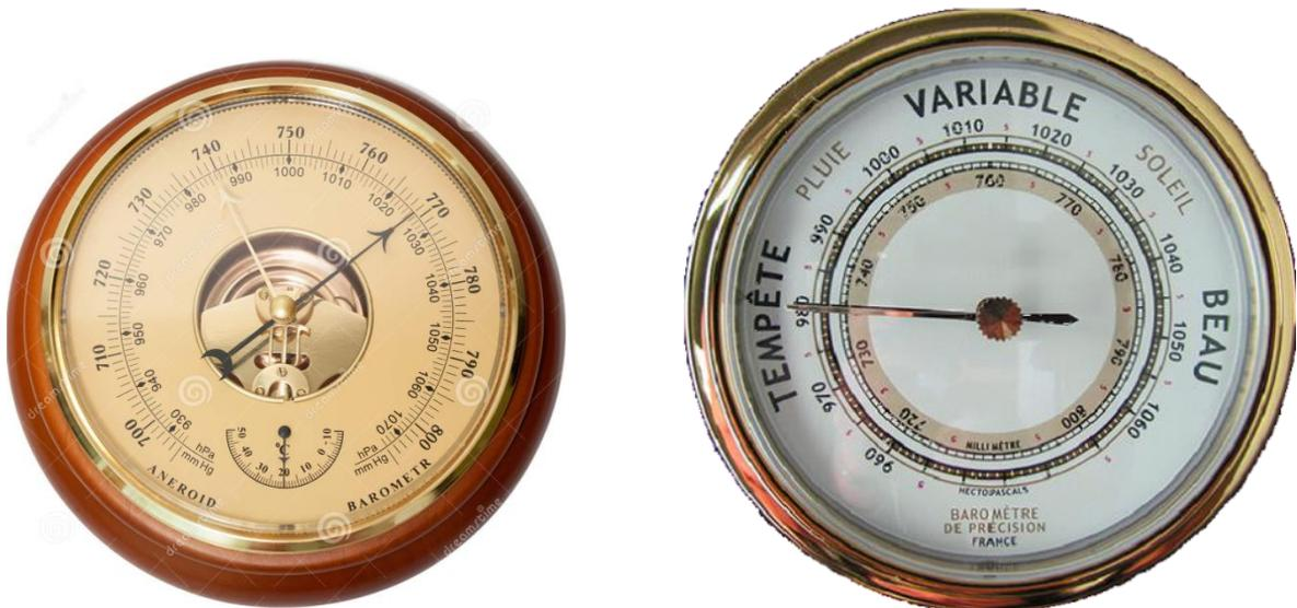
**Fig. 2.12 : Baromètre anéroïde**
